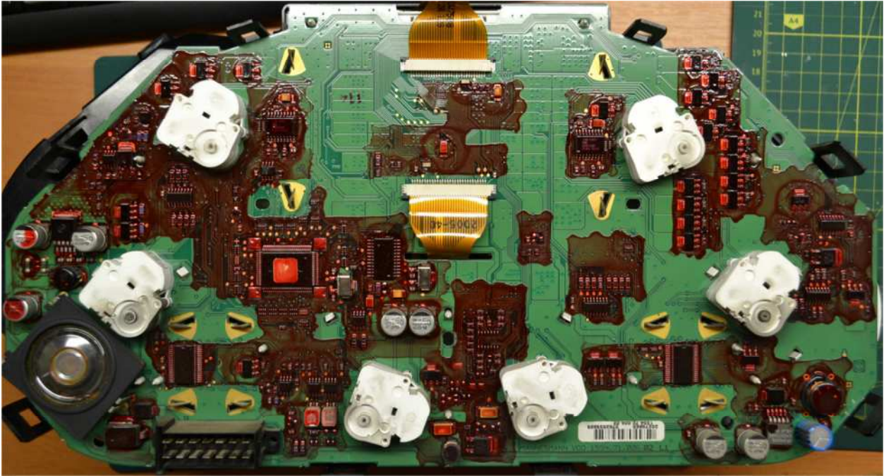
DAF Euro3 kontrol paneli panosu örneği
